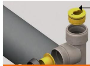
**!** Pour le calibre 32, serrer en butée le bouchon laiton avec la clé spécifique à ce bouchon après soudure et refroidissement de l'ensemble.
